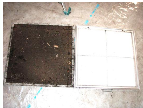
排ガスで黒く汚れたプレフィルタと新品の比較
